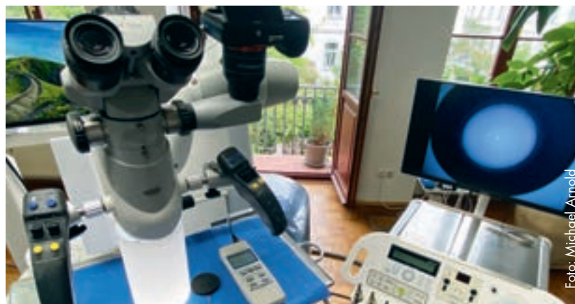
Abb. 6: Standardisierte Messung mit einem Luxmeter bis 400.000lx: Als Vergleichswert dient die erste Messung der neuen Lampe, so dass der Abfall der Leistung objektiv verfolgt werden kann.
