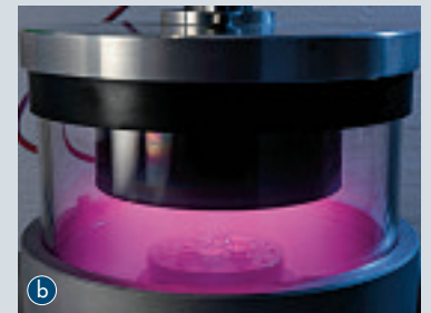
Abb. 2: (a) Labor mit Sputter-Coater für die Gold-/Palladiumbeschichtung der Proben, Trockner für die überkritische Trocknung mit flüssigem Kohlendioxid, um biologische Proben ohne Kontraktion zu trocknen, Inkubator zum Kultivieren von Fe-Mikroben und einem Autoklav für die Desinfektion; (b) Detail des Sputter-Coaters mit violett glühendem Gold-Argon-Plasma.
