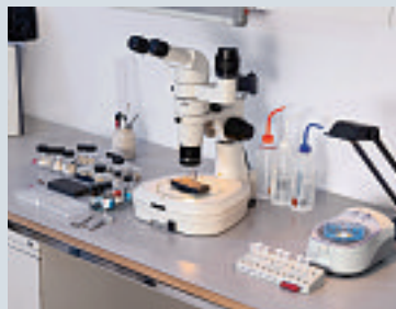
Abb. 1: Arbeitsplatz mit Binokularmikroskop für die Probenpräparation, Reinigungs- und Fixierflüssigkeiten, Ethanol in steigender Konzentration zum Austrocknen und elektrisch leitenden Adhäsiven zur Herstellung des REM-Präparats
