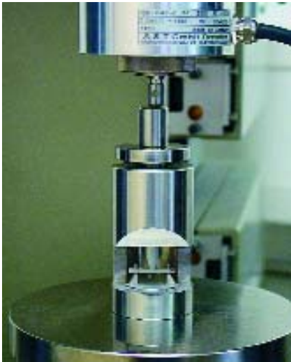
Abb. 7a: Dreipunkt-Biegeversuch mit der Universalprüfmaschine
