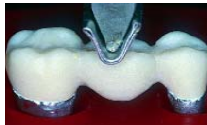
Abb. 1: Prüfungsanordnung zur Festigkeitsprüfung dreigliedriger Seitenzahnbrücken (Empress 2)
