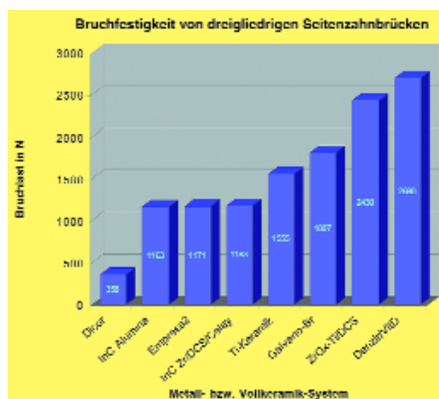
Abb. 4: Festigkeitsprüfung von dreigliedrigen Seitenzahnbrücken mit vergleichbarem Design und Prüfprotokoll
