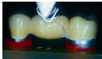
Abb. 2: Frakturbild einer dreigliedrigen Seitenzahnbrücke mit einem Zirkoniumoxidgerüst
