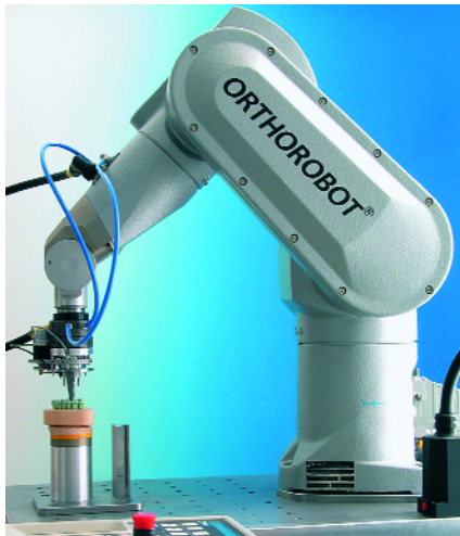
Abb. 4a und b: Wichtigstes Werkzeug im Orthorobot-Laborprozess: Ein sechsschiger Industrieroboter (Fa. Stäubli) mit einer Positioniergenauigkeit von 0,02 mm (links). Bracket-Haltervorrichtung mit Ormco-Bracket (rechts) – durch „Fingerwechsel“ ist jeder Bracket- und Röhrchen-Typ ideal positionierbar (Abbildungen Silli).
