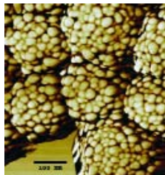
Füllkörper von Nanocompositen: Einzelne Nanoteilchen lagern sich traubenförmig zusammen, in so genannten Nanoclustern.
