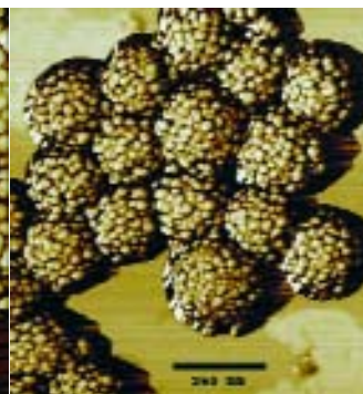
Füllkörper von Nanocompositen: Einzelne Nanoteilchen lagern sich traubenförmig zusammen, in so genannten Nanoclustern.
