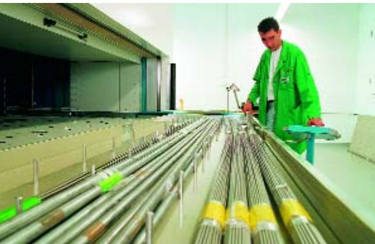
Aus meterlangen Titanstangen werden kleinste Implantatteile, aber auch sie werden bereits bei der Anlieferung überprüft.
