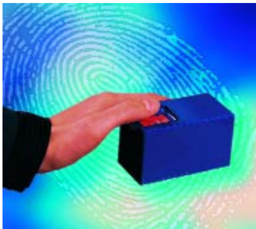
Ein Fingerzeig genügt: Beim Fingerabdruckverfahren werden die einzelnen Hautlinien auf Finger und Daumen vermessen.
