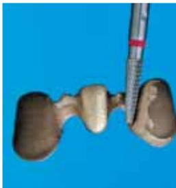
haltige Legierungen) beziehungsweise 15 000 min<sup>-1</sup> (alle anderen Metall-Legierungen) angewandt werden. Für die Edelmetallbearbeitung empfiehlt Komet Werkzeuge mit E-, EF-, oder UM-Verzahnung, zum Beispiel den HM Fräser H138EF. Für die Bearbeitung von NEM-Legierungen sind Werkzeuge mit FSQ- oder UM-Verzahnung sinnvoll, zum Beispiel der HM-Fräser H138FSQ.
