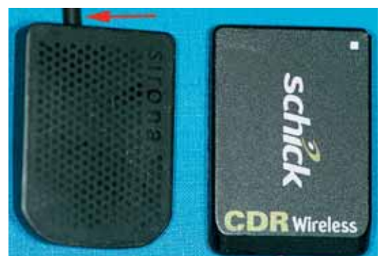
Abbildung 4: Zwei Beispiele für Festkörpersensoren. Links: CCD-Sensor „Full Size“ (Sirona Dental Systems GmbH, Bensheim). Der Pfeil zeigt auf die Kabelausleitung. Rechts: Kabelloser CMOS-Sensor (Schick Technologies, Inc., Long Island City, NY, USA. In Deutschland vertrieben über orangedental GmbH & Co KG , Biberach)
