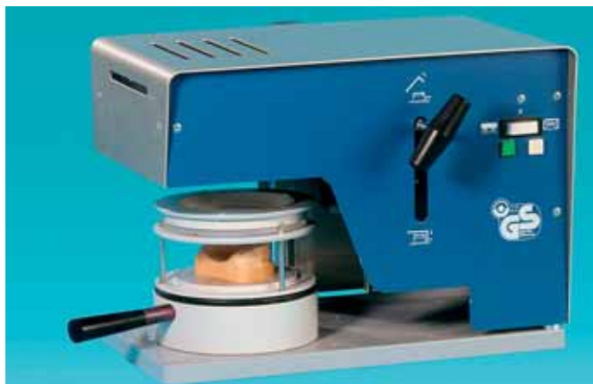
Abbildung 4 a, b: Mundschutz aus Ethyl-Vinyl-Acetat mittels Tiefziehtechnik
