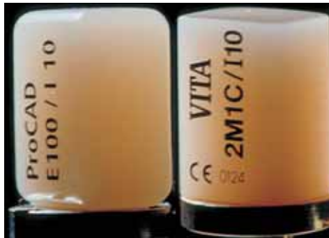
Abbildung 1: Blockkeramiken Mark II (Vita), ProCAD (Ivoclar Vivadent). Ästhetische, hochglashaltige Keramiken, aus feldspathischen oder synthetischen Aluminosilikatgläsern als Matrix, mit unterschiedlichen hoch schmelzenden Glasfüllerzusätzen (Nephelin, Albit beziehungsweise Leuzit) [Kelly].
