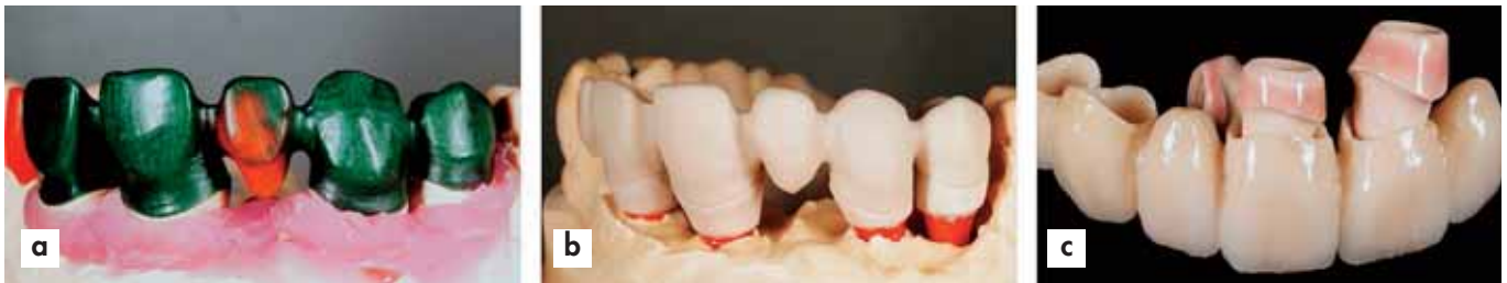
Abbildung 8: a) Wax-up abgetastet mit Cerec inLab, b) Kontrolle der Passgenauigkeit des mit inLab formgeschliffenen In-Ceram Classic Zirconia Gerüsts, c) Abutments und Brücke fertig gestellt [Cristou].
