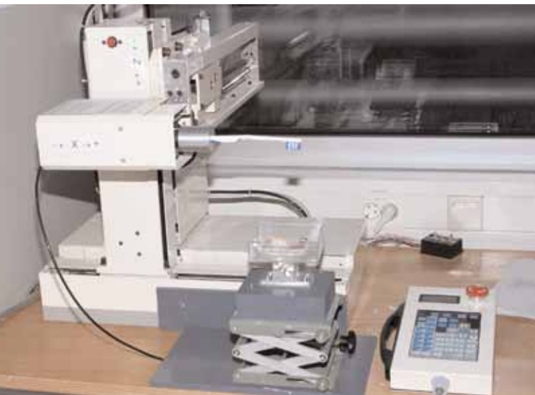
Abbildung 1: Robot SR 5383 mit eingespannter Test- zahnbürste und Mo- dellträger Vorrichtung
