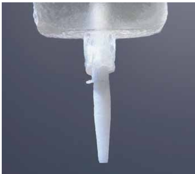
Abbildung 4: Cytec blanco Glasfaserstift mit einem Durchmesser von 1,8 mm und mit einer Einsetztiefe von 10 mm nach Zugversuch. Der Stift ist vollständig mit Panavia F bedeckt.
