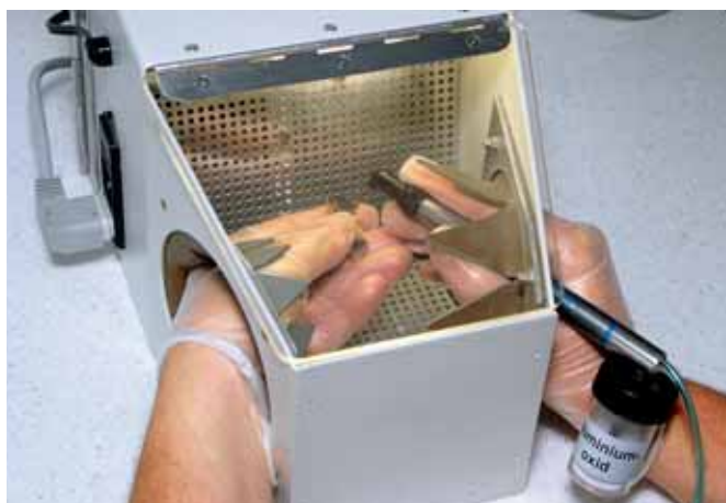
Abbildung 2: Anwendung des Abstrahlgerätes in einer kleinen mobilen Absaugbox, durch die unangenehme Strahlstäube im Behandlungszimmer weitgehend vermieden werden können.
