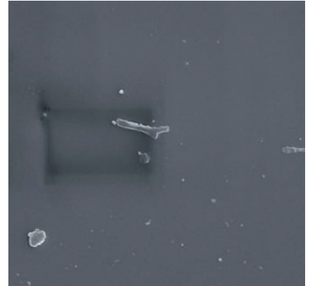
Abbildung 14: REM-Aufnahme der Oberfläche der mit „Safety Lock“-Beschichtung versehenen DentinPost, SE-Bild, 1 000x
