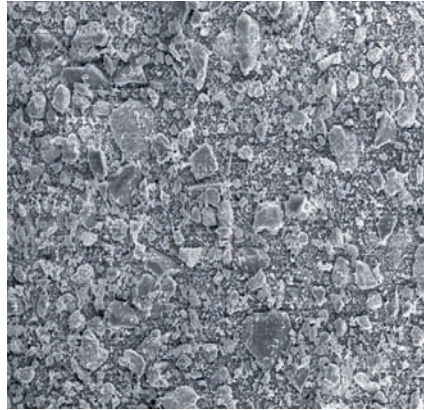
Abbildung 13: REM-Aufnahme der DentinPost Coated-Oberfläche, ein Jahr gealtert, SE-Bild, 1 000x
