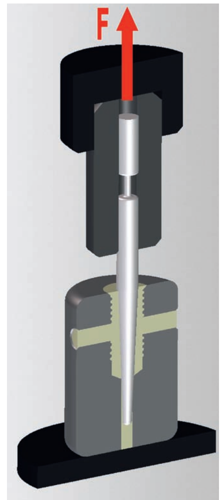
Abbildung 3: Schemazeichnung des Abzugsversuchs
