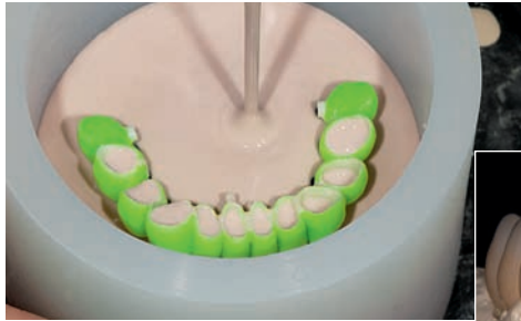
Abbildung 4: Einbetten des CAD/CAM-gefrästen Waxups zur Gewinnung einer gepressten Verblendung
