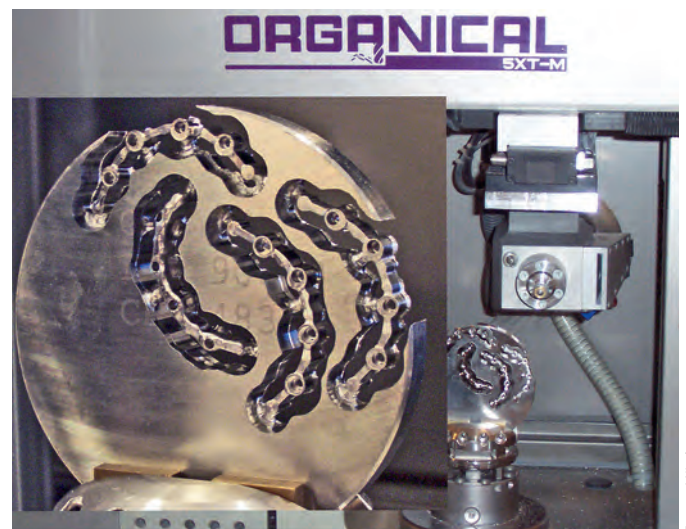
CAD/CAM gefräste Implantat-Mesostrukturen sind heute passgenau möglich. Fünf-Achs-Systeme und offen digitale Schnittstellen (wie hier R&K Organical) erlauben Loan-Production aller Konstruktionsvarianten. Die Software ist intuitiv handhabbar, aber auch die Fräseinheiten selbst sind in Bedarfgröße mittlerweile erschwinglich.
