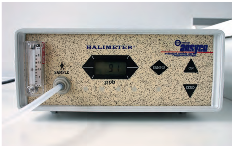
Abbildung 2: Halimeter zur Messung flüchtiger Schwefelverbindungen
