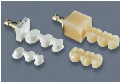
Abbildung 6: Rapid-Layer-Verblendung links: ZrO 2 -Gerüst gefräst und gesintert rechts: Verblendung ausgeschliffen und poliert
