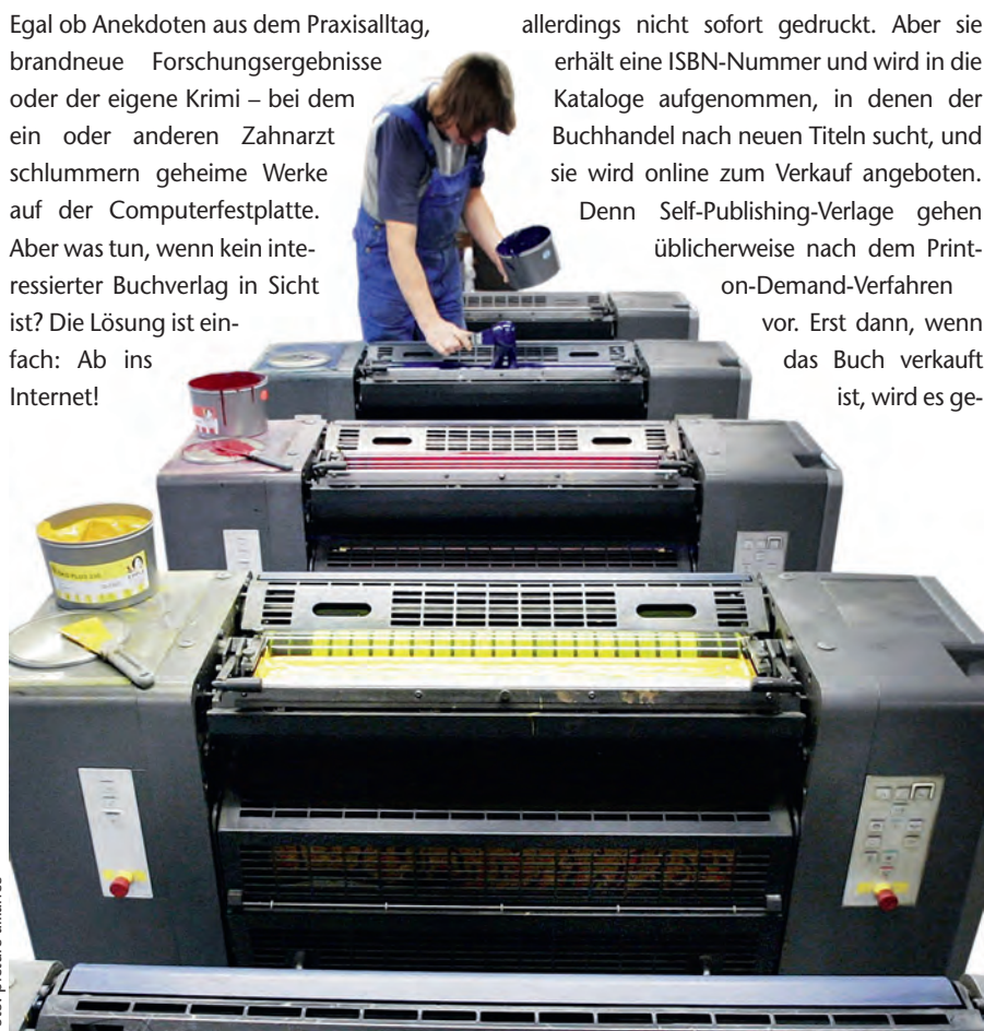
Das Print-on-Demand-Verfahren ist ein sicheres Geschäft für alle Beteiligten. Mit der Produktion – zum Beispiel auf einer hier gezeigten 4-Farb-Offset-Druckmaschine – und der anschließenden Verarbeitung des Buches wird erst begonnen, wenn das Exemplar verkauft ist.
