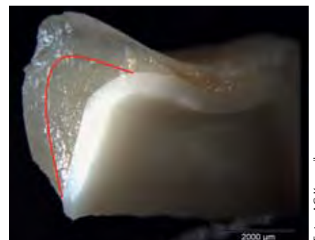
Abbildung 9: Eine fehlende Höckerunterstützung für die Verblendung erhöht das Chipping-Risiko.
