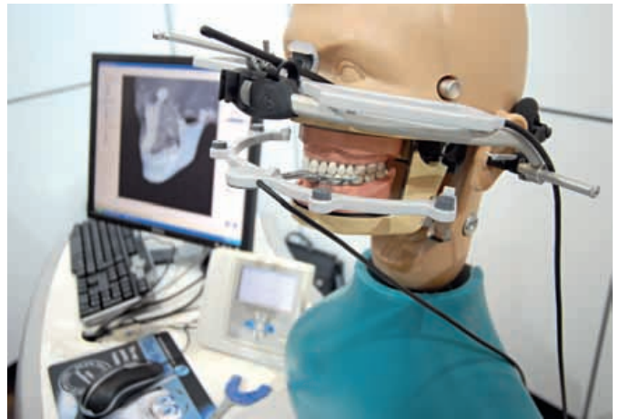
Abbildungen 2 und 3: Die Digitalisierung des klassischen Artikulators: Ziel ist die Reduzierung notwendiger Einschleifzeiten in der Praxis.
