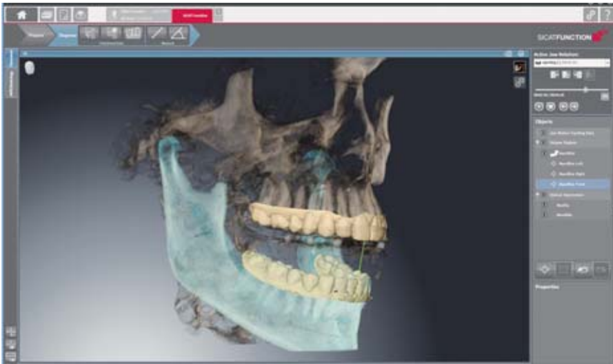
Abbildung 8: Synthese von DVT, Zahnkranz-Scan (intra- oder extraoral) und digitaler Funktionsanalyse: Michigan-Schienen können direkt aus den Datensätzen gefräst werden.
