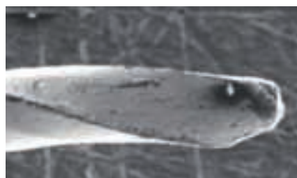
Abbildung 12a bis 12c: Maschinell betriebene Feilen werden heute meist für die einmalige Anwendung angeboten. Die Abbildungen zeigen die Abnutzung nach einer (Mitte) und drei (rechts) Anwendungen.
