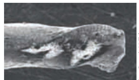
Abbildung 12a bis 12c: Maschinell betriebene Feilen werden heute meist für die einmalige Anwendung angeboten. Die Abbildungen zeigen die Abnutzung nach einer (Mitte) und drei (rechts) Anwendungen.
