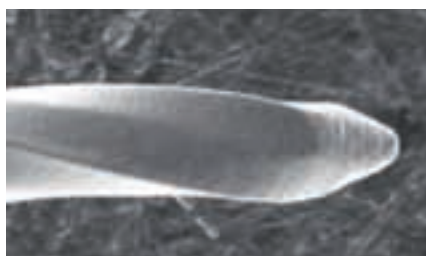
Abbildung 12a bis 12c: Maschinell betriebene Feilen werden heute meist für die einmalige Anwendung angeboten. Die Abbildungen zeigen die Abnutzung nach einer (Mitte) und drei (rechts) Anwendungen.
