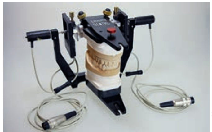
Abbildung 4: Beispiel für ein stationäres, elektronisches Kondylenpositions-Messinstrument (hier: E-CPM, Fa. Gamma Dental) mit Positionierung der Ober- und Unterkiefer-Modelle in maximaler Interkuspitation.
