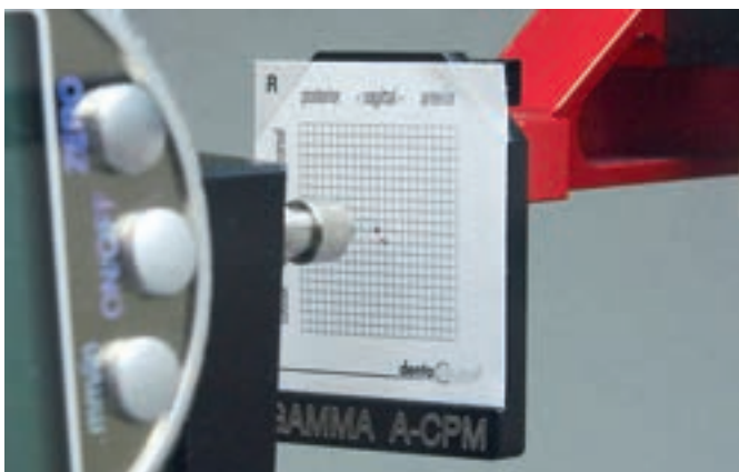
Abbildung 3: Erfassung der sagittalen Messpunkte am stationären Kondylenpositions-Messinstrument (hier: Cadiax E-CPM, Fa. Gamma Dental), die Auswertung erfolgt später auf dem Befundbogen Kondylenpositionsanalyse.
