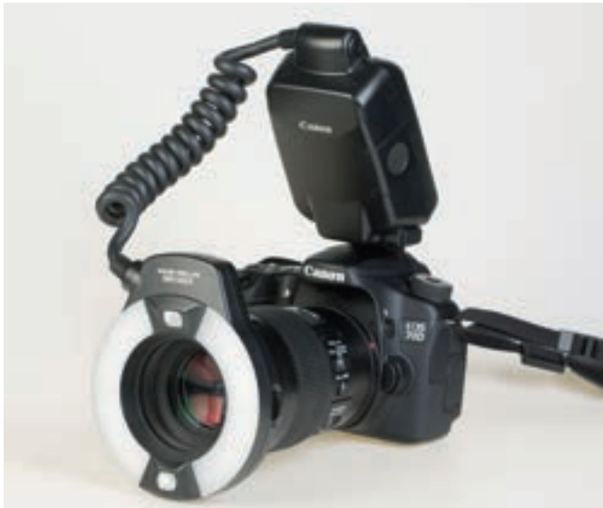
Eine digitale SLR-Kamera mit Makroobjektiv und Ringblitz ermöglicht eine schattenlose und direkte Ausleuchtung der Mundhöhle.
