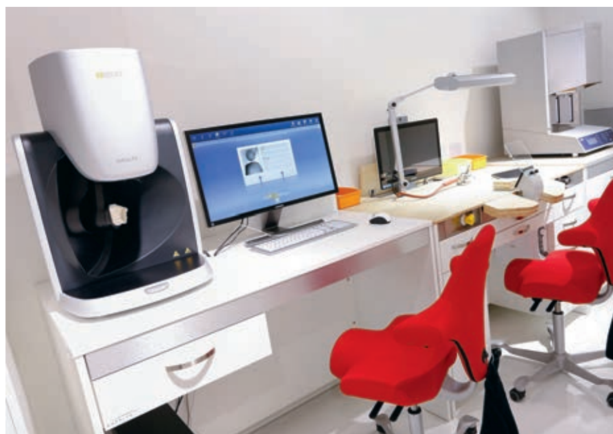
Das Equipment für diejenigen, die in die Fertigung zahntechnischer Objekte einsteigen möchte: Extraoralscanner, Software, Bearbeitungseinheit
