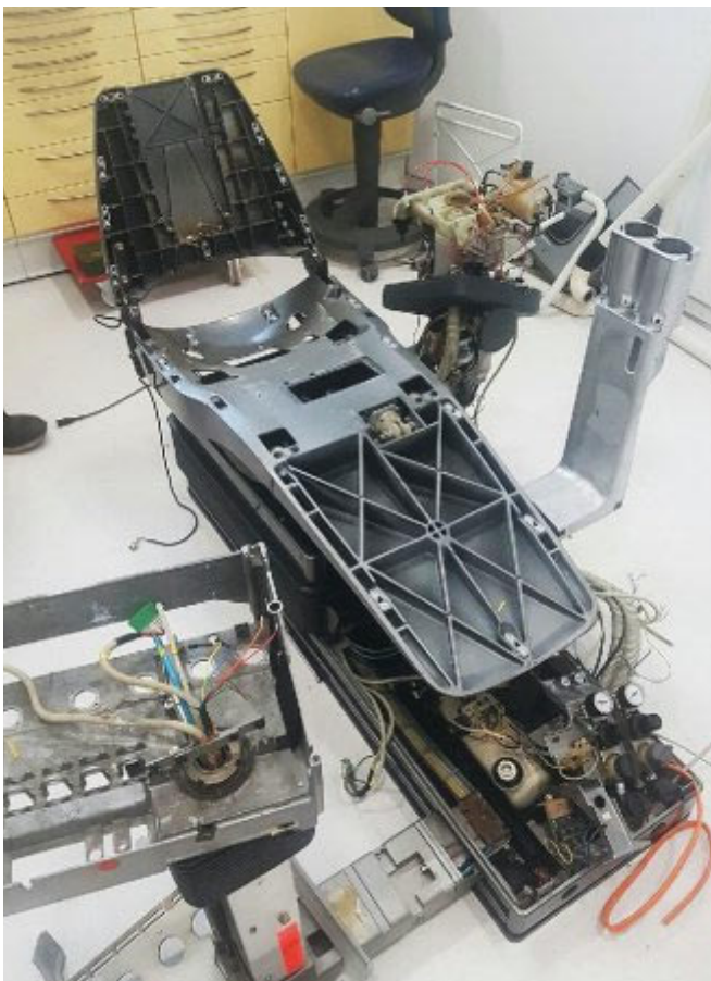
Das „Skelett“ der Einheit: Hier wird die Einheit abgebaut. Auf seinen Wunsch behält der Besitzer das alte Innenleben als Reserve für seine andere M1. Die alte Technik wird vollkommen entnommen.
