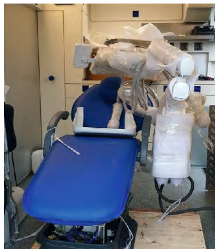
Bis ein Rettungswagen zum Zahnmobil umgebaut worden ist, vergehen schon zehn Wochen. Die Kosten liegen bei mindestens 40.000 Euro, wenn der Käufer einen Rettungswagen stellt. Optimal ist ein Modell mit montierter Liege – dort kann später der Stuhl verschraubt werden.
