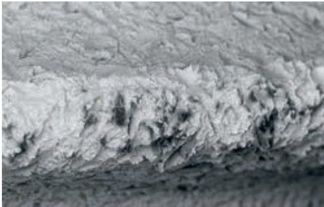
Abbildung 5: Organische Partikel auf Außengewinde einer chinesischen Straumann-Kopie (500x)
