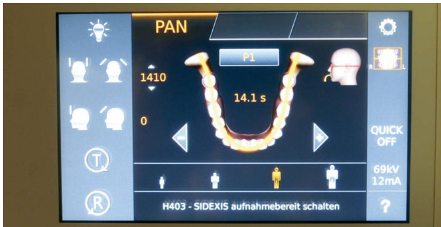
Abbildung 3: Easypad des Orthophos SL, Auswahl von Aufnahmeparametern in mehreren Ebenen
