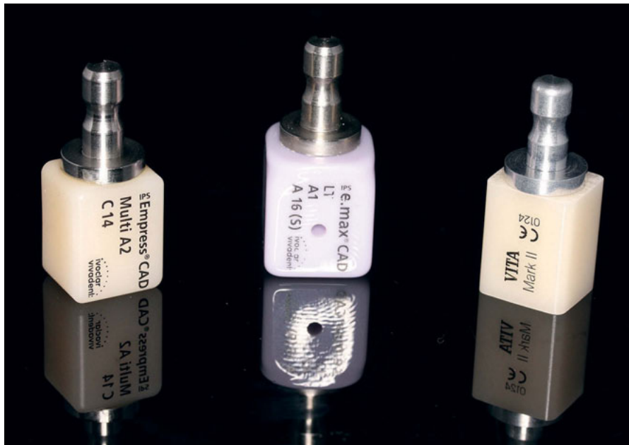
Abbildung 3: Keramikrohlinge für die CAD/CAM-Fertigung (Mitte: Rohling mit vorgefertigter Adaption an ein Abutment im vorkristallisierten („blauen“) Zustand)
