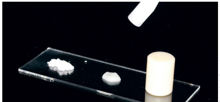
Abbildung 2: Die Standardoptionen der keramischen Verarbeitung: Pulver, Paste, Pressling und Spray
