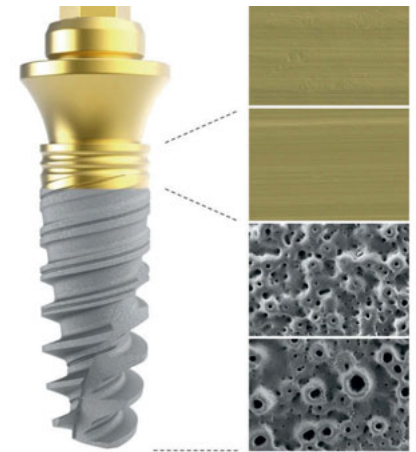
Abbildung 4: Angepasste Rauigkeit: Je nach Gewebeposition weist dieses Implantat eine angepasste Struktur und weitere biologisch relevante Eigenschaften auf (Nobel Biocare).
