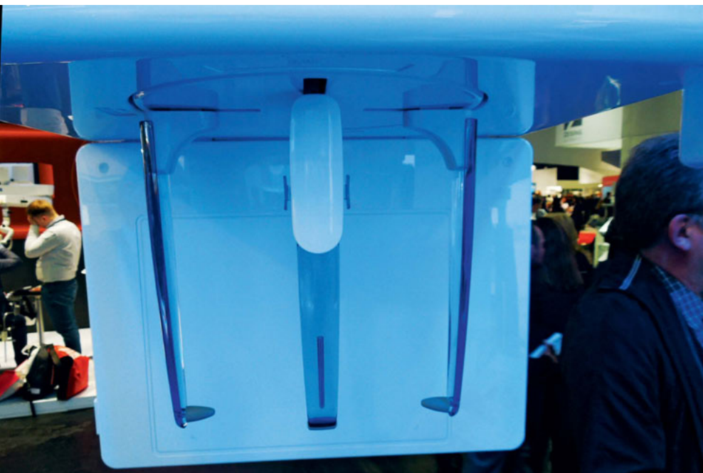
Abbildung 1: FRS-Linien-Sensor mit schneller Scan-Bewegung im Gehäuse
