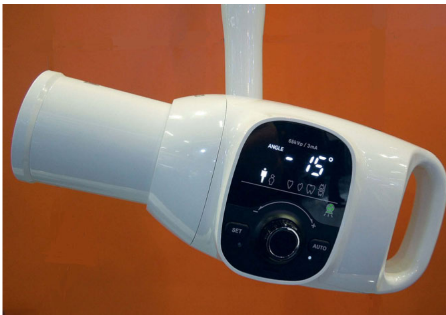
Abbildung 3: Kleiner handlicher Tubus-Strahler mit Neigungsanzeige
