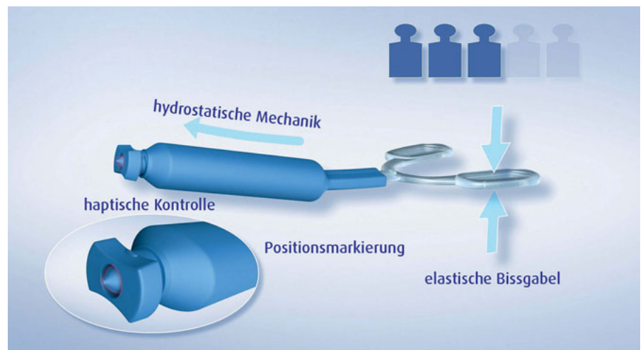
Abbildung 5: Darstellung der Funktion des RehaBite®: Wird auf die elastische Aufbissgabel eine Kraft ausgeübt, wird über eine hydrostatische Mechanik eine haptische Feedbackkontrolle aus dem Gehäuse ausgetrieben.
