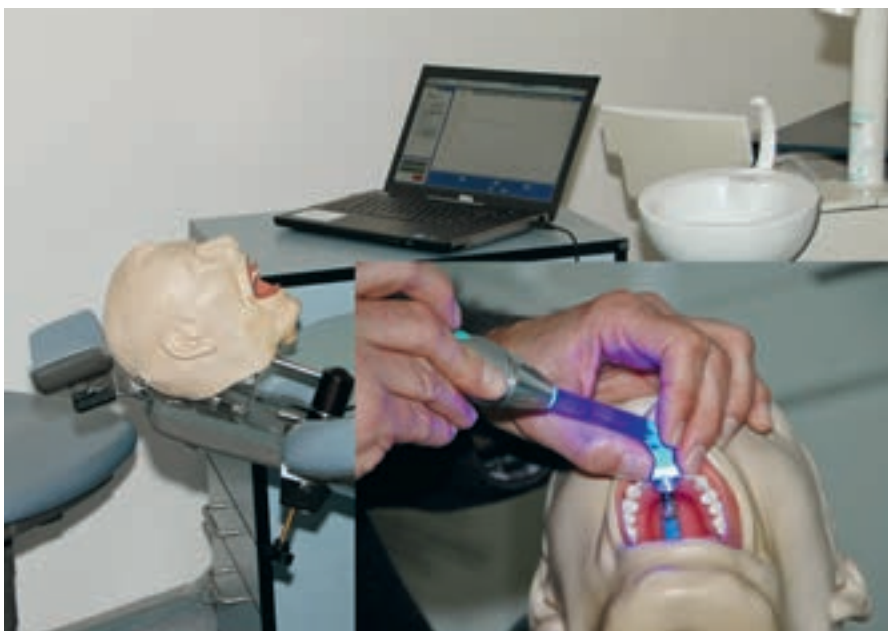
Abbildung 11: MARC®-Phantomkopf mit kalibrierten Sensoren im Front- und im Seitenzahnbereich zur Aufzeichnung der Bestrahlungsstärke während der Anwendung für eine simulierte Lichthärtung
