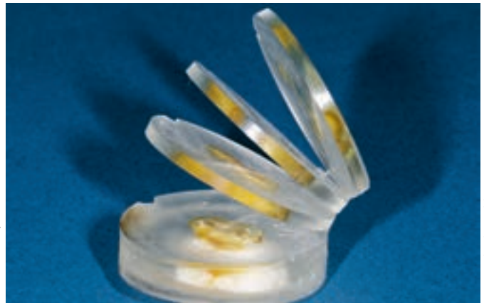
Abbildung 5: Nach Kunststoffeinfettung können je nach Untersuchungsaufgabe Quer- oder Längsschliffpräparate zur mikroskopischen Beurteilung hergestellt werden. Eine Anfärbung ist für anatomische Fragestellungen meist nicht mehr erforderlich.
