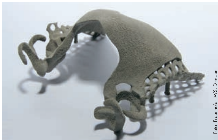
Abb. 1: Additiv gefertigte, metallische Prothesenbasis: Nahezu beliebige Geometrien können mit additiven Verfahren hergestellt werden.
