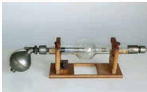
Röntgenröhre aus dem Jahr 1928
