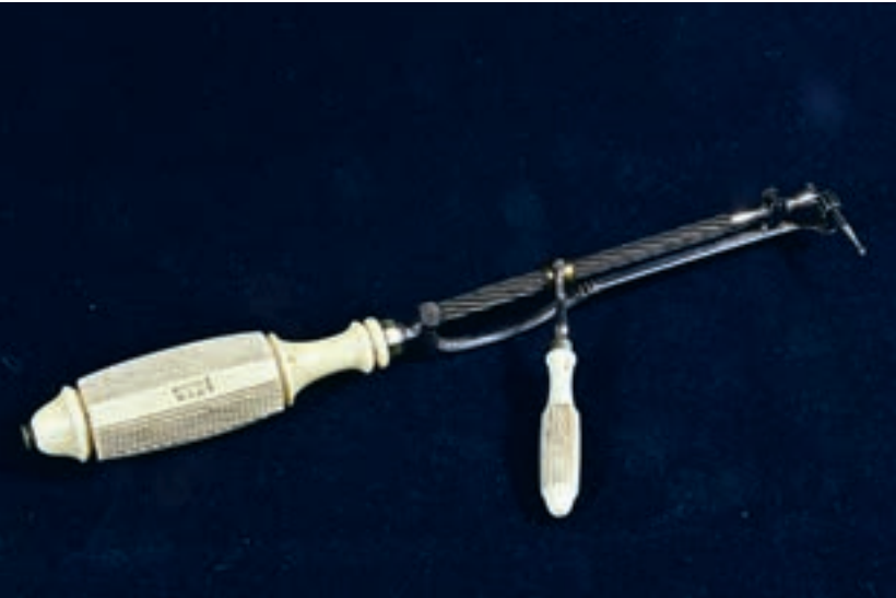
Dieser archimedische Drillbohrer nach Mac Dowell wurde von der Firma Lühr (varierende Schreibweise) aus Paris um 1860 hergestellt, Stahl vernickelt und verzierte Elfenbeingriffe. Diese Bohrmaschine stammt aus der Sammlung Proskauer/Witt.
