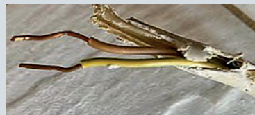
Isolierung eines Kupferdrahts aus einem Stromkabel
