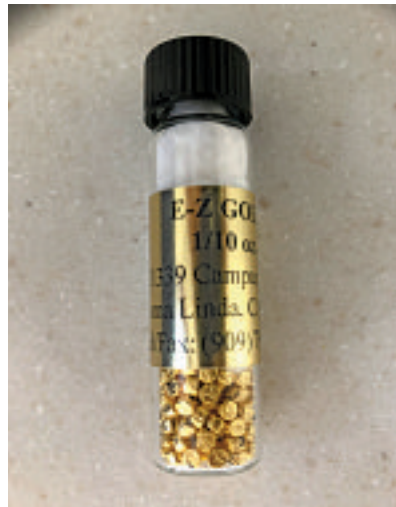
Abb. 7: E-Z-Gold: Hierbei wird Goldpulver in eine Goldfolie gewickelt und mit Wachs stabilisiert, das vor dem Einbringen in die Kavität über einer Flamme entfernt wird.
