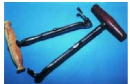
*Schlüssel mit einfacher Biegung, rotierbarer Krallen, verschieden fixierbar, zirka 1800*
