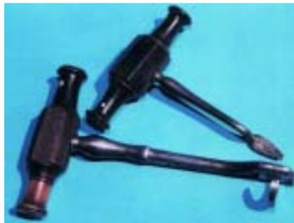
*Schlüssel mit Hebel, Griff abschraubbar, Griff aus Horn, zirka 1850*
