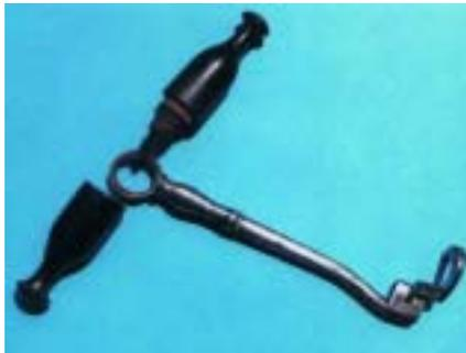
Schlüssel mit aufschraubbarem Griff, in dessen Mitte sich der Schraubenzieher befindet, zirka 1860
