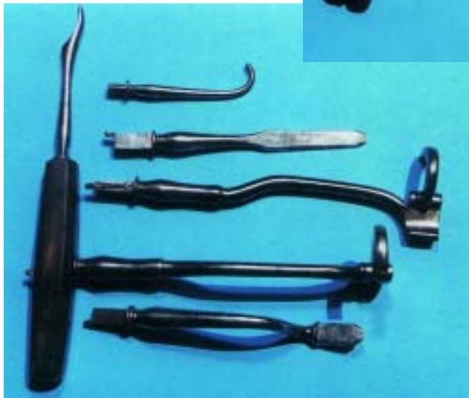
*Instrument, das sowohl als Schlüssel wie als Hebel benutzbar ist, Horngriff mit verschiedenen Aufsätzen, zirka 1820*
