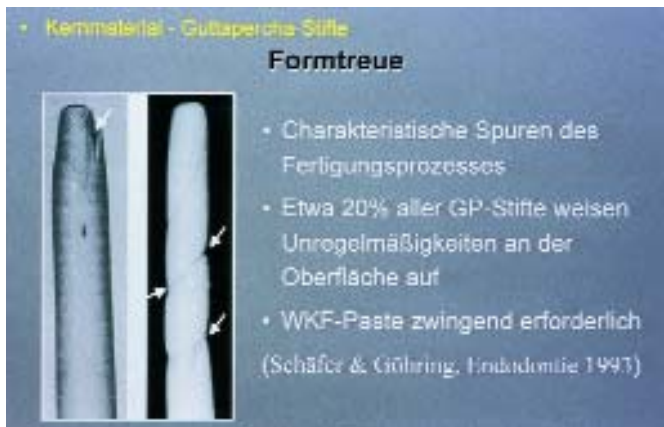
Abb. 6: Charakteristische Oberflächendefekte der Guttaperchastifte, bedingt durch den Herstellungsprozess
