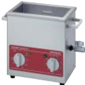
Eine neue Produktreihe von Ultraschall-Reinigungsgeräten stellt Bandelin electronic vor. Die innovative Idee der Sonorex-Longlife-Geräte liegt in der außergewöhnlich hohen Materialstärke von zwei Millimetern des für die Schwingwannen verwendeten V4A-Edelstahls. Die Wanne wird bei dieser neuen Serie nicht
