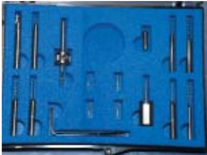
Der Friktions- und Führungsstift nach Alfons Wengenmeier wird weder gelötet noch geschweißt, sondern verschraubt. Dies hat Vorteile: Reparaturen sind durch das Auswechseln der Stifte möglich – eine einzigartige Option bei individuellen Geschieben, Teleskopen, Konuskronen, Schröder-
