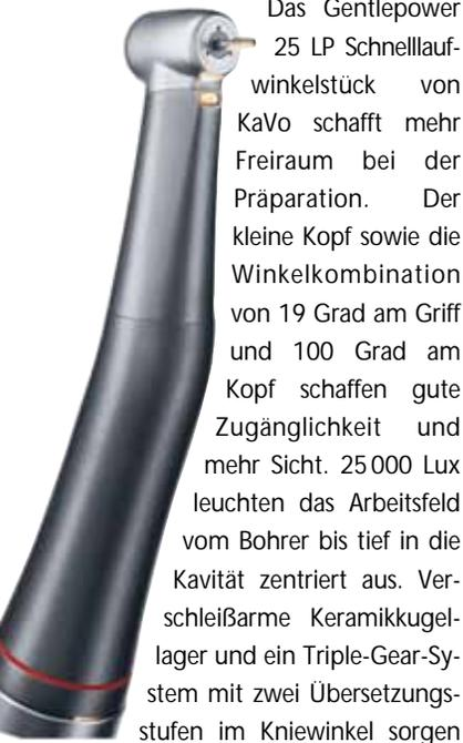
Das Gentlepower 25 LP Schnellaufrückwinkelstück von KaVo schafft mehr Freiraum bei der Präparation. Der kleine Kopf sowie die Winkelkombination von 19 Grad am Griff und 100 Grad am Kopf schaffen gute Zugänglichkeit und mehr Sicht. 25 000 Lux leuchten das Arbeitsfeld vom Bohrer bis tief in die Kavität zentriert aus. Verschleißarme Keramiklager und ein Triple-Gear-System mit zwei Übersetzungsstufen im Kniewinkel sorgen
