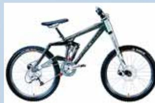
Diese Fahrräder sind besonders gefedert und verfügen über eine hohe Rahmensteifigkeit sowie standfeste Bremsanlagen.
