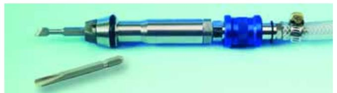
luftleitung angeschlossen wird. Er liegt gut in der Hand und ermöglicht ein sicheres Ausbetten. Durch den Betriebsschalter am Handstück ist er flexibel einsetzbar. Speedo-Ex ist geräuscharm, einfach zu bedienen und leicht zu reinigen. Der Meißel misst 15
