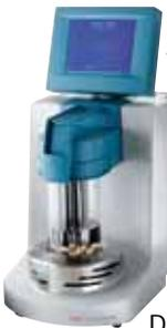
Das Galvanogerät Micro von Wieland wird nach acht Jahren durch die Neuentwicklung MicroVision abgelöst. Auf dem Gehäusematerial namens Varicor hinterlässt selbst heißes Goldbad keine Flecken. Durch einen Riegelverschluss des Galvanokopfes am Becherglas kann dieses samt Inhalt zu einem Waschbecken transportiert werden, um die galvanisierten Teile dort zu entnehmen. Die Teile sind durch wieder verwendbare Magnetkontakte einfach zu befestigen. Das Goldbad enthält eine höhere
