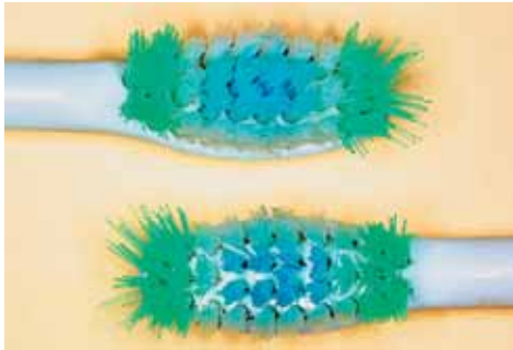
Abb. 10: Abgenutzte Borsten der Sonicare™ nach vier Wochen. Die Köpfe müssen ausgetauscht werden.
