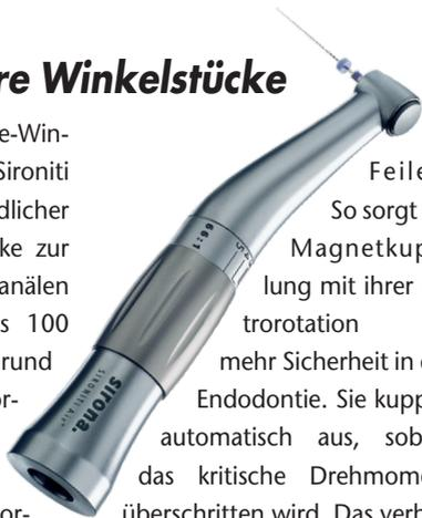
Feilen. So sorgt die Magnetkuppelung mit ihrer Retrorotation für mehr Sicherheit in der Endodontie. Sie kuppelt automatisch aus, sobald das kritische Drehmoment überschritten wird. Das verhindert, dass die Feile im Wurzelkanal blockiert und senkt das Feilenbruchrisiko.
