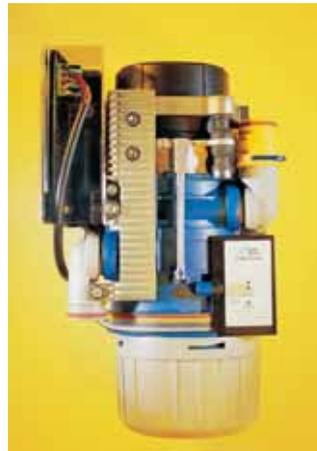
Die neue Generation der Separiersysteme und Amalgamscheider von Dürr Dental eignet sich auch zum Nachrüsten bereits vorhandener Einheiten. Die CAS 1 Combi-Separatoren beziehungsweise die CS 1 Combi-Sepamaticen haben durch den zweistufigen Aufbau der Separierstufe mit Zyklonabscheider und Separationsturbine eine gegenüber herkömmlicher Technik vielfach höhere „tro-
